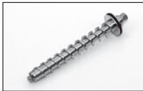
De standaard toevoerschroef (gekenmerkt door een zwarte dichtingsring) is geschikt voor alle oliehoudende zaden, pitten en noten. Door de bijzondere vormgeving van de schroefdraad aan het begin van de toevoerschroef wordt het persgoed fijngemalen en snel verwerkt.
