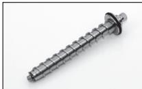
Een bijkomende toevoerschroef met een voor kleinere zaden geoptimaliseerde schroefdraad (gekenmerkt door een rode dichtingsring) is in het bijzonder voor hard, klein persgoed geschikt. Door de kleinere schroefdraad wordt minder zaadgoed getransporteerd. Zo is een optimaal persen bij lage temperatuur en verminderde vermogensopname van de motor gegarandeerd.
