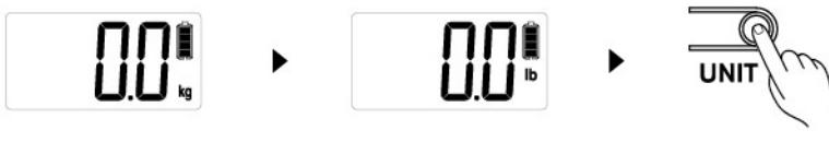
Drücken Sie die kleine Taste auf der Rückseite des Gerätes um die Gewichtseinheiten zwischen **kg** und **lb** umzustellen.
