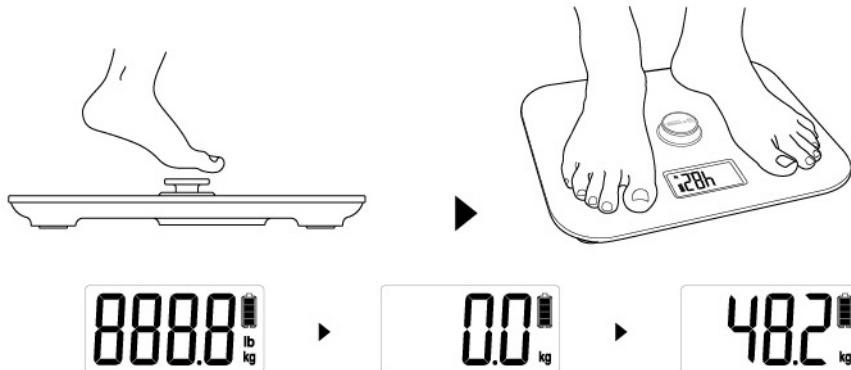
Premere con il piede o la mano il tasto finché il condensatore, tramite tecnologia dinamo, è completamente caricato.
