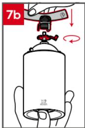
Remonter le mécanisme, la molette et la poignée
