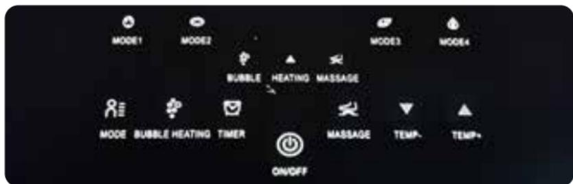
Drücken Sie die **ON/OFF-Taste**, um das Wasserbad mit Massagefunktion zu starten. Nach dem Einschalten schalten Sie **BUBBLE HEATING** für die Sprudelfunktion ein und heizen Sie das Wasser bis zu der von Ihnen gewünschten Temperatur auf, um dann eine konstante Temperatur zu erhalten.
