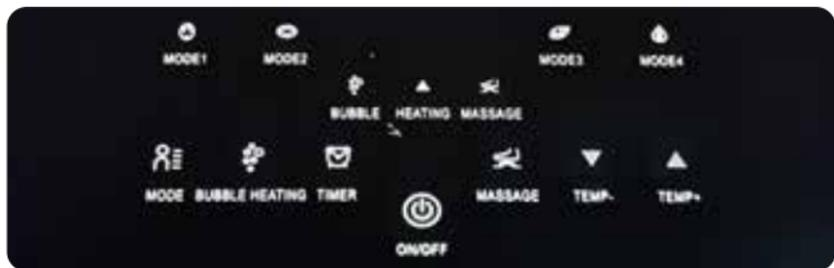
Druk op de **ON/OFF knop** om het waterbad met massagefunctie te starten. Schakel na het inschakelen **BUBBLE/HEATING** in voor de bubbelfunctie en verwarm het water tot de gewenste temperatuur en houd de temperatuur vervolgens constant.
