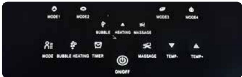
Appuyez sur le bouton **ON/OFF** pour démarrer le bain d'eau avec fonction de massage. Après la mise sous tension, allumez **BUBBLE/HEATING** pour la fonction de bain bouillonnant et chauffez l'eau jusqu'à la température que vous souhaitez, puis maintenez une température constante.
